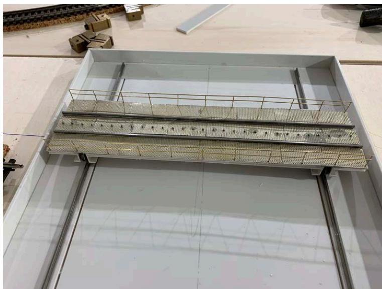
Heute mal etwas für die Feinmotoriker unter den Lötfetischisten von uns. Es geht um den Geländerbau aus Messingdraht.
