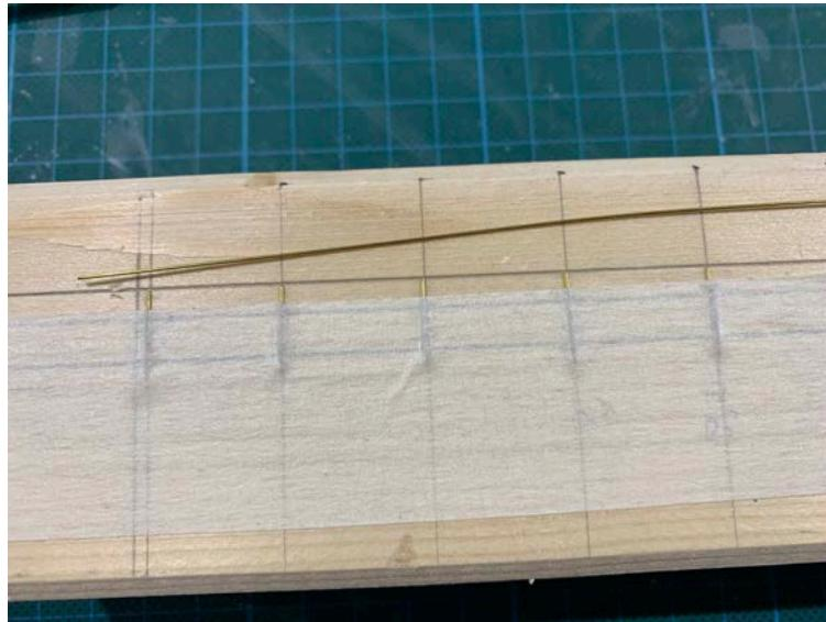
Bevor man nun den Handlauf anlötet richtet man mit Hilfe eines Lineals die Stützen auf gleicher Höhe aus.
