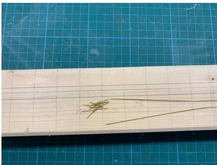
Der Fußabstand beträgt hier 20mm und der Abstand der Handläufe 4,5mm. Anschließend schneiden wir mit einem Seitenschneider die benötigten Bauteile zurecht. Die Geländerstützen haben in diesem Fall eine Länge von 13mm.
