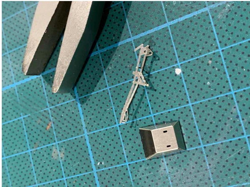
Nun werden die Kanten der Blechwanne mit etwas Lötfett bestrichen und mit möglichst wenig Lot verlötet.
